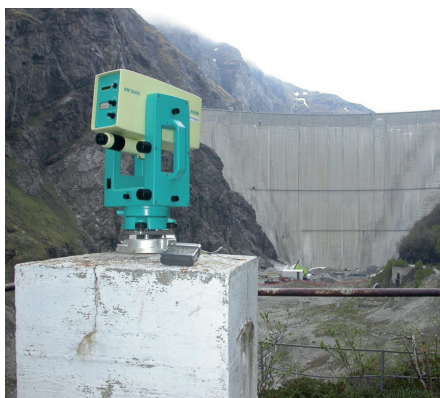
Abb. 8: Kern Mekometer ME5000 (1994) vor der Staumauer «Mauvoisin» (© Pöry Schweiz AG).
