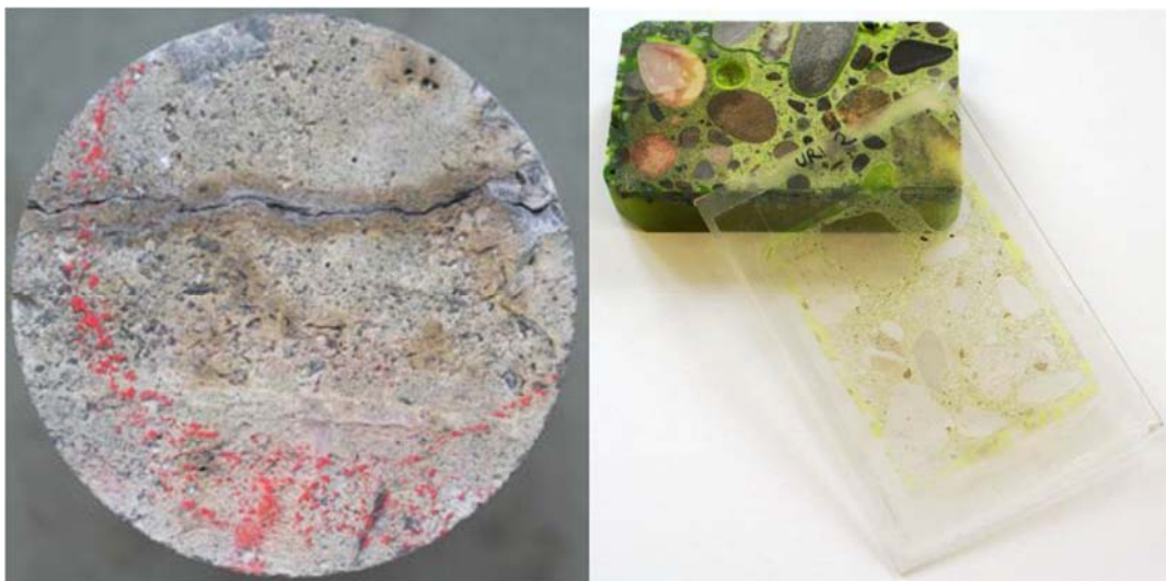
Figure 6: Surface d'une carotte de béton d = 100 mm avec fissure due à la RAG (gauche) et échantillon de béton 50 \times 90 mm avec une tranche fine imprégnée pour examen avec microscope optique (droite) [10].
