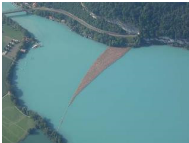
Figure 33: Barrières à BF sur le lac de Brienz lors des crues de 2005 (Photo: Office Fédéral de l'Environnement, Suisse).
