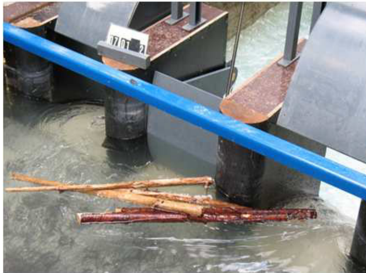
Figure 36: Obstruction d'ouvertures ouvertes d'un déversoir avec système à trois ouvertures (Hartlieb 2015)
