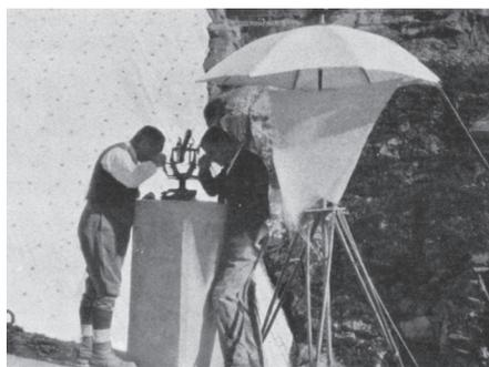
Fig. 2: observation avec un théodolite Hildebrand à un axe, réseau de «Barberine» (Lang 1929).
