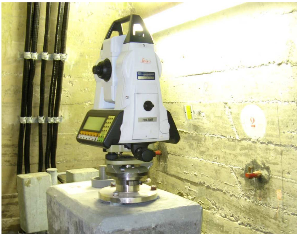
Abbildung 10: Einmessung des Lotdrahtes
