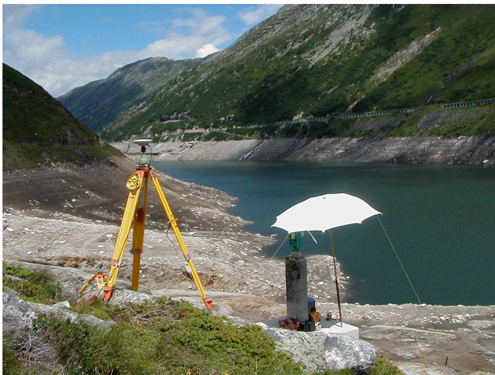
Abbildung 11: GNSS-Messung in Kombination mit Präzisions-Distanzmessung
