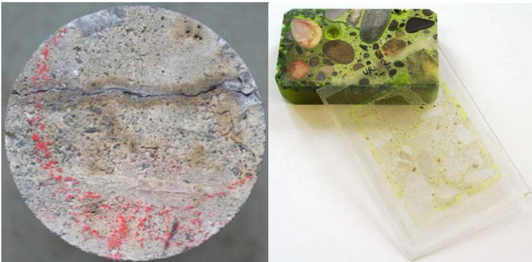
**Abbildung 6:** Oberfläche eines Bohrkerns  $d = 100$  mm mit Riss infolge AAR (links) und Betonprobe  $50 \times 90$  mm mit imprägniertem Dünnschliff für Untersuchungen unter dem Lichtmikroskop (rechts) [10].
