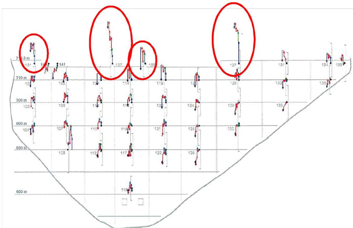
**Abbildung 53:** Verschiebungen der Messpunkte auf der Mauerluftseite (1984–2008).
