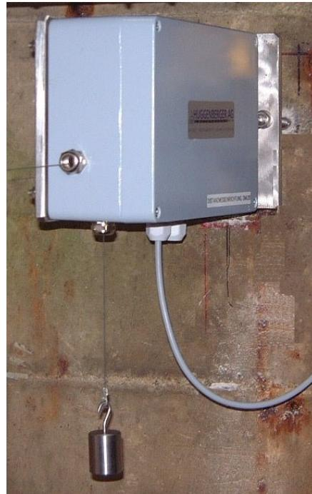
**Abbildung 63:** Kontinuierliche Messung von Temperatur und relativer Feuchte - Verformungsmessung mit Invardraht.
