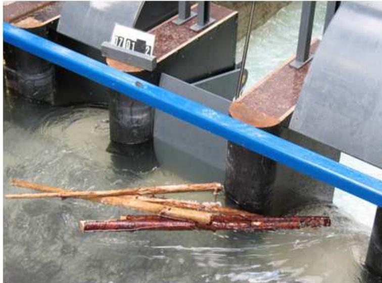
**Abbildung 36:** Verklausung bei geöffneten äusseren Wehrfeldern einer dreifeldrigen Wehranlage (Hartlieb 2015)
